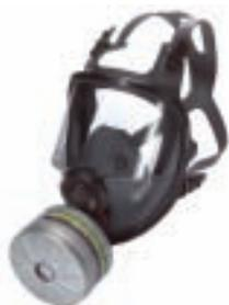
Maschera leggera classe 2 in elastomero morbida e confortevole, bardatura a 4 cinghie, guarnizione di tenuta a doppia flangia. Elevata resistenza alle sostanze chimiche, schermo in policarbonato resistente agli impatti ed ai graffi. Certificata secondo la EN136, monta filtri con raccordo a vite Rd40.
