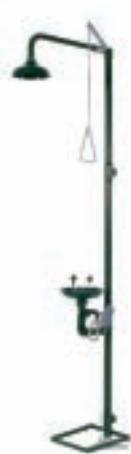
**ISC710** - Doccia "DILUVIO®" combinata con lavaocchi, con soffione in polipropilene completo di valvola a chiusura manuale con azionamento a mezzo tirante rigido con comando a triangolo. Lavaocchi a flusso aerato completo di valvola a chiusura manuale con apertura a mezzo di push laterale, pedale, vaschetta in polipropilene. Versione tutta in acciaio inox **ISC710X**
