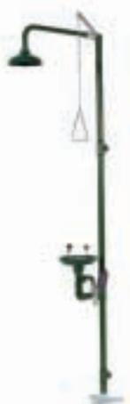
**ISC700** - Doccia "DILUVIO®" combinata con lavaocchi, con soffione in polipropilene completo di valvola a chiusura manuale con azionamento a mezzo tirante rigido con comando a triangolo. Lavaocchi a flusso aerato completo di valvola a chiusura manuale con apertura a mezzo di push laterale e vaschetta in polipropilene. Versione tutta in acciaio inox **ISC700X**
