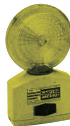
art. 1/ 2000 Lanterna con dispositivo crepuscolare monobatteria a led, luce lampeggiante gialla con interruttore manuale. Schermo in policarbonato antiurto.
