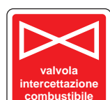
valvola intercettazione combustibile AZIONARE IN CASO D'INCENDIO 5315 A F
