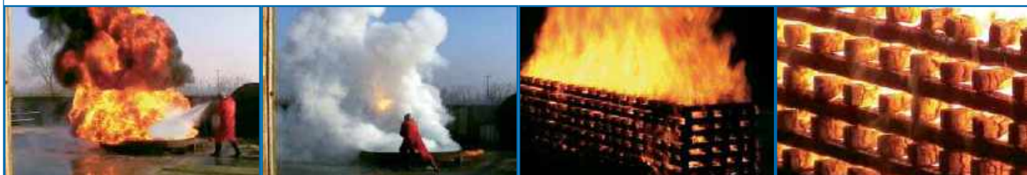
Prova di spegnimento classe 233B ( 155 lt di eptano ) con estintore a polvere da 6 kg
